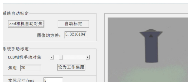
图5 对比度低的铆钉图像的方差计算
